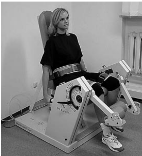
Ryc. 1. Widok stanowiska do badania siły mięśni stawu kolanowego, wykonywanych w warunkach dynamicznych
